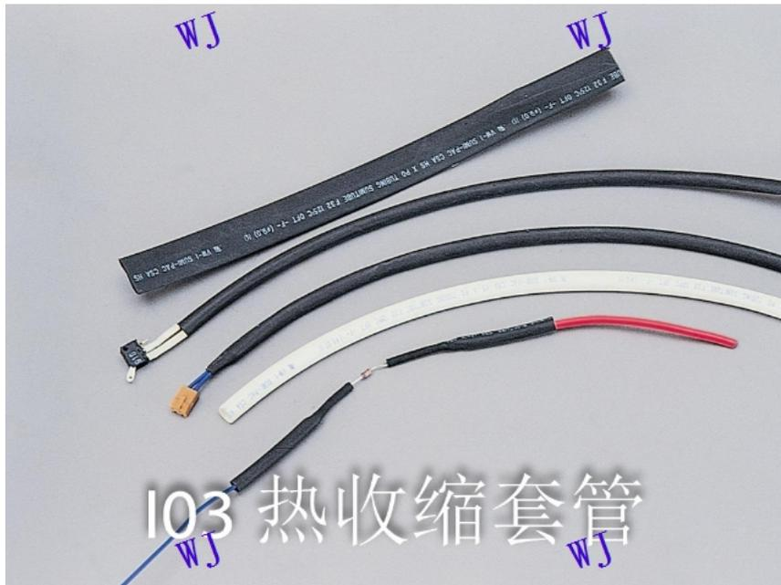
无锡伟哲配线器材有限公司向您介绍我司正在销售的绝缘套管PVC热收缩管具有具有高温收缩、柔软阻燃、绝缘防蚀功能。广泛应用于各种线束、焊点、电感的绝缘保护，金属管、棒的防锈、防蚀等。电压等级600V高分子材料随着温度由低到高要经历玻璃态—高弹态，玻璃态时性能接近塑料，高弹态时性能接近橡胶。热缩管所用材料在室温下是玻璃态，加热后变成高弹态。使用：生产时把热缩管加热到高弹态，施加载荷使其扩张，在保持扩张的情况下快速冷却，使其进入玻璃态，这种状态就固定住了。在使用时一加热，它就会变回高弹态，但这时载荷没有了，它就要回缩。如遇需要购买绝缘套管可向无锡伟哲配线器材有限公司询价，可按照客户的要求进行定制，我们将竭诚为您提供一条龙及周到的服务！宿迁品质绝缘套管销售厂家全国专业生产绝缘套管销售——无锡伟哲配线器材有限公司。
